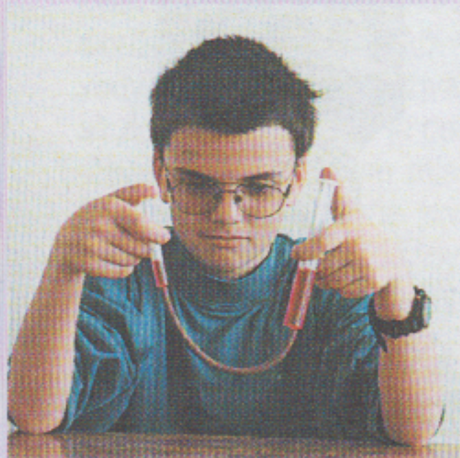
72. Injekční stříkačka – model hydraulického zařízení
